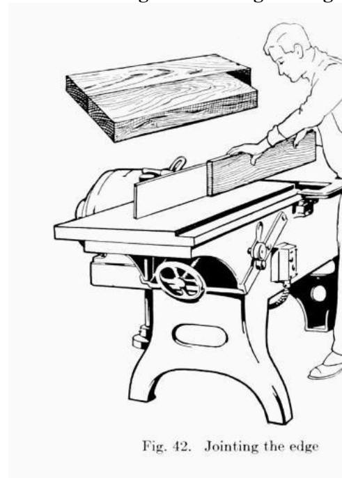
Fig. 42. Jointing the edge
